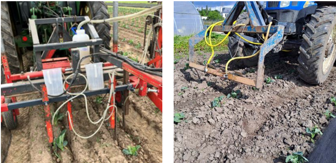
Figuur 17. Machinale toepassing van aaltjes is mogelijk met een slangenpomp, die aaltjes met behulp van schoffelmessjes naast de plantvoet afzet over de volledige lengte van de rij (links) of die met RTK-GPS per plant apart aaltjes afzet (rechts).
