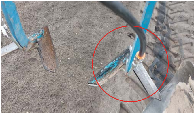
Figuur 19. Aansluiting van de persluchtslangen op de schoffelelementen, waarop buisjes gelast werden.
