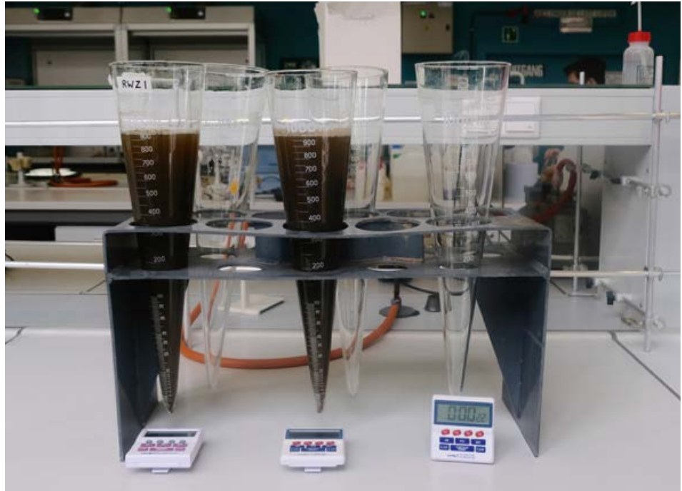
Een test in het 'Labo milieutechnologie' waarbij de slibbezinkbaarheid bepaald wordt. Dit is een belangrijke parameter voor het bepalen van slibkwaliteit naar bezinken toe. Deze bepaalt hoeveel gezuiverd water er geloosd kan worden en hoeveel spuislib er is. credit: hogeschool Gent
