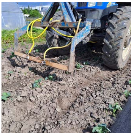
Figuur 1: Machinale toepassing van aaltjes is mogelijk met een slangenpomp, die aaltjes met behulp van schoffelmessen naast de plantvoet afzet over de volledige lengte van de rij (links) of die met RTK-GPS per plant apart aaltjes afzet (rechts).
