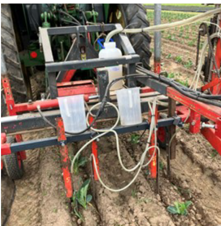
Figuur 1: Machinale toepassing van aaltjes is mogelijk met een slangenpomp, die aaltjes met behulp van schoffelmessen naast de plantvoet afzet over de volledige lengte van de rij (links) of die met RTK-GPS per plant apart aaltjes afzet (rechts).
