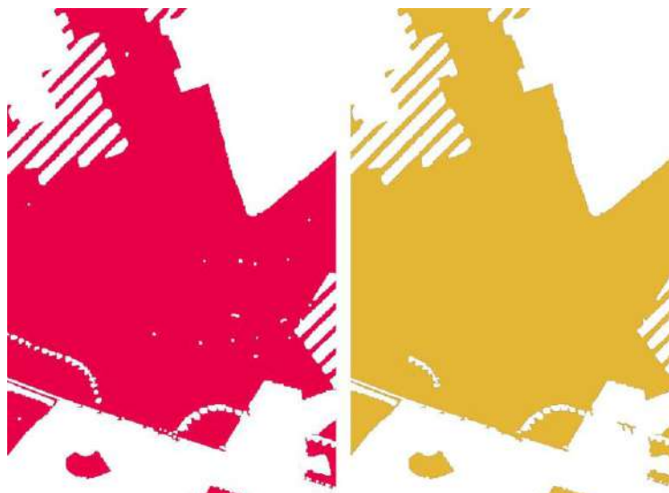
Figuur 4.17: Opvullen van gaten kleiner dan 5000m 2 in de polygonen. Links voor en rechts na de operatie
