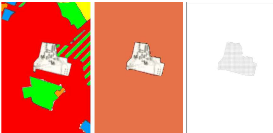
Figuur 4.20: Procedure voor het vinden en invullen van witte gebieden. Links, kaart met een oningevuld wit gebied, midden, alle ingekleurde polygoonen samengevoegd tot één enkele polygoon, rechts de nieuwe ingevulde polygoon
