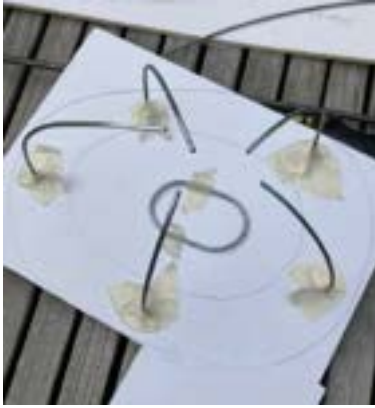
stalen frame lamp gebogen & laten lassen
