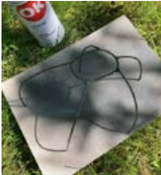
stalen frame zwart spuiten & punten frame schuren zodat ze perfect in het frame passen
