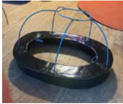
stalen frame zwart spuiten & punten frame schuren zodat ze perfect in het frame passen
