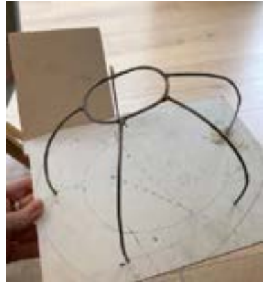
stalen frame lamp gebogen & laten lassen
