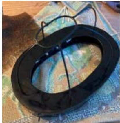
stalen frame zwart spuiten & punten frame schuren zodat ze perfect in het frame passen
