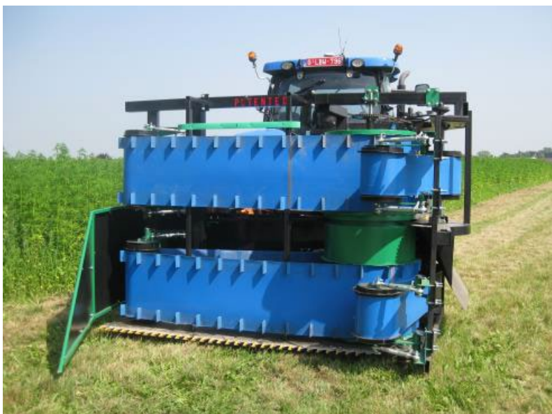
Figuur 2.3. Prototype oogstmodule hennep voor lange vezeldoeleinden, ontwikkeld door de firma Hemplinvest (getoond op 26-06-2019 te Bottelare – werking niet gedemonstreerd).
