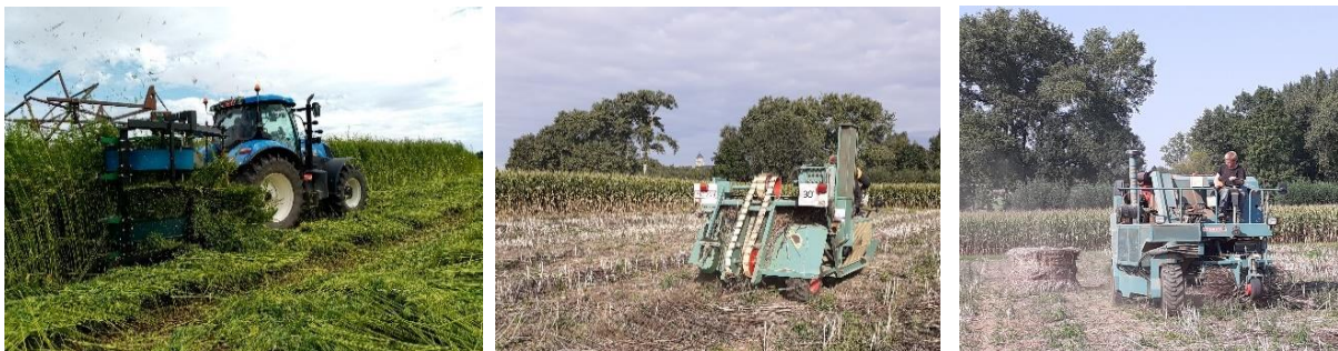
Figuur 1. Snijden door HempInvest (links), keren (midden) en persen in ronde balen (rechts) van hennep voor de zwingellijn in zomer 2020 (Bottelare)
