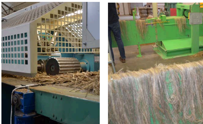
Figuur 18: Het proces van zwingelen waarbij hennepstro wordt gescheiden in lange vezels, korte vezels, scheven en stof. Links: Invoer aan zwingellijn, het breken. Rechts: Hennep lange vezels na zwingelen.
