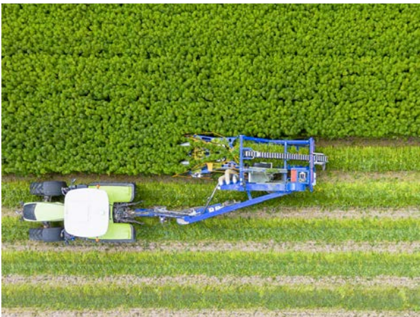
Figuur 13: Oogstmachines voor de teelt van hennep voor textiel. Links: oogstmachine van Cretes (foto Cretes). Rechts: oogstmachine van Hyler (foto Hyler).
