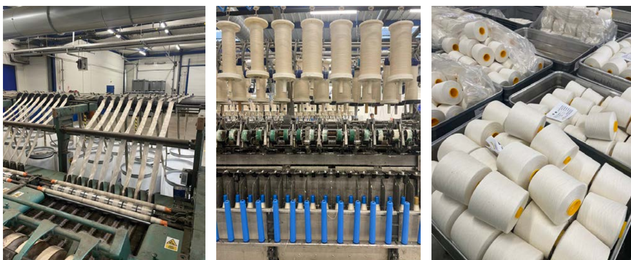
Figuur 20: Het proces van spinnen waarbij garen gemaakt worden. Links: Hekellintjes. Midden: Mengen en strekken van de hekellintjes. Rechts: Afgewerkt product.
