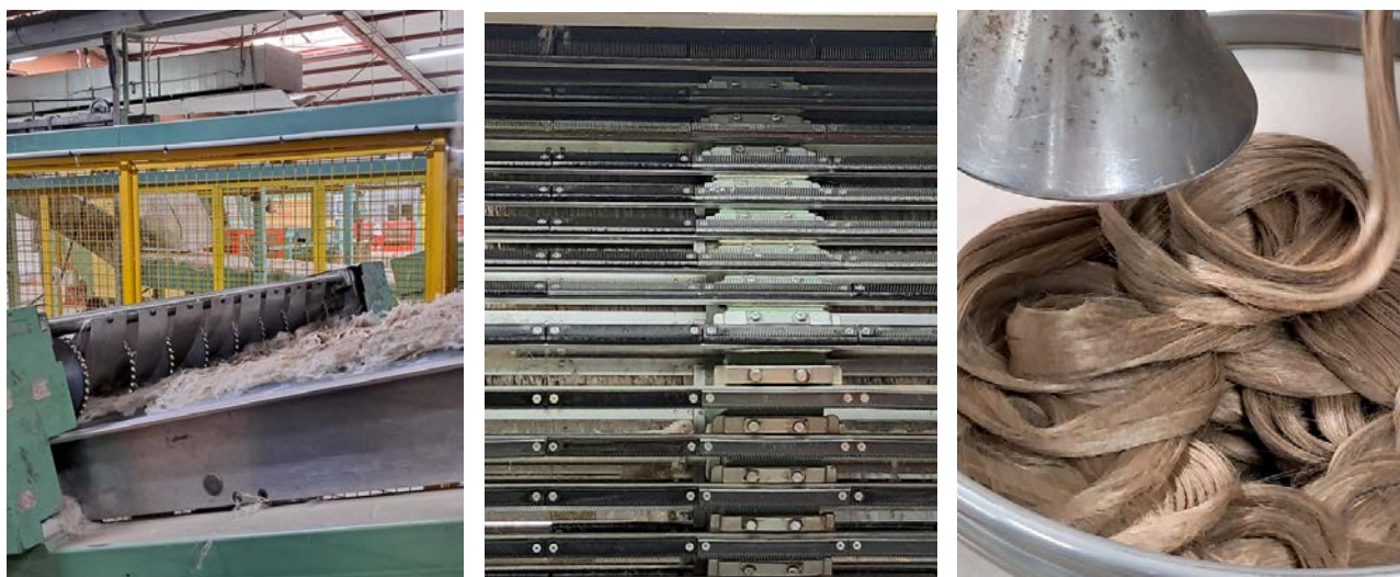
Figuur 19: Het proces van hekelen. Links: Invoer voor hekelen. Midden: Hekelen. Rechts: Uitvoer van hekelen met hekellint.
